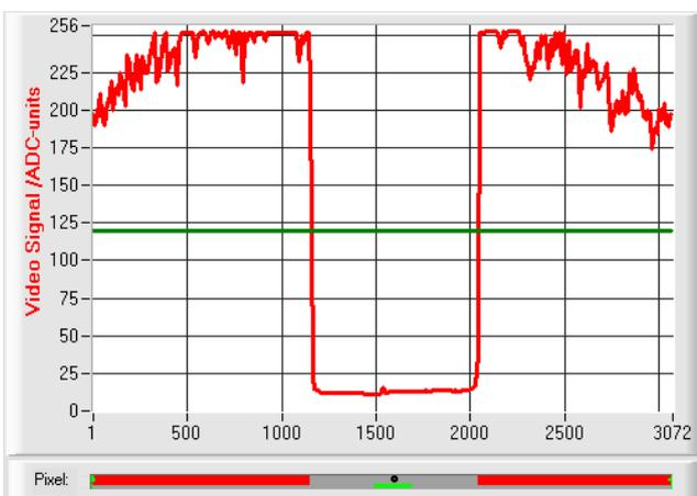
Aus den beiden Schnittpunkten zwischen der Video-Schwelle (grüne horizontale Linie) und dem Intensitätsverlauf (rote Kurve) können zwei Pixel ermittelt werden, bei denen der Hell/Dunkel-Übergang stattfindet. In der nebenstehenden Abbildung wird der zweite Hell/Dunkel-Übergang am Pixel Nr. 2047, der erste Hell/Dunkel-Übergang bei Pixel 1155 erkannt.
