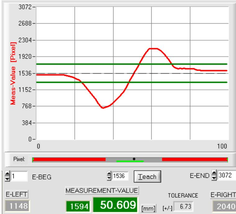
Nach Anklicken der RUN-Taste wird der aktuelle Messwert im graphischen Anzeigefenster im „Roll-Modus“ dargestellt. Hierbei laufen die Messwerte als rote Kurve von rechts nach links durch das graphische Anzeigefenster.
