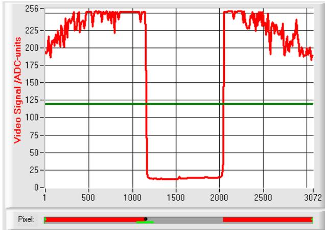
Als Kriterium zur Erkennung der Kanten dient der Übergang zwischen belichteten und abgedunkelten Bereichen im Intensitätsverlauf der CCD-Zeile.
