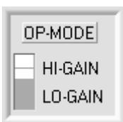
( II ): Binärschalter zur Einstellung der Verstärkung an der CCD-Zeile.
