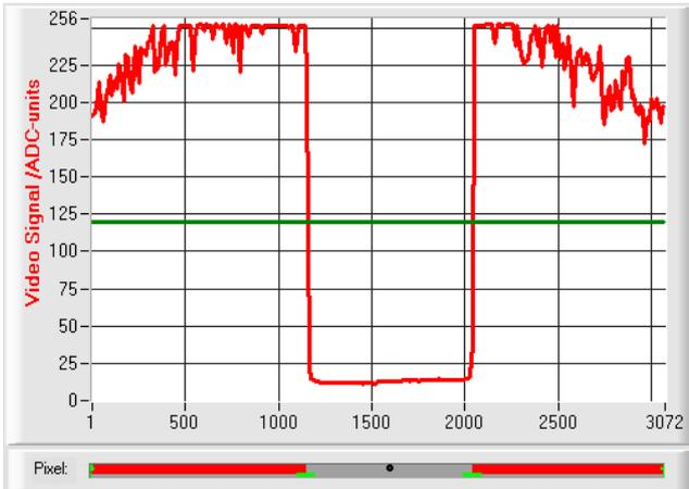
Aus den beiden Schnittpunkten zwischen der Video-Schwelle (grüne horizontale Linie) und dem Intensitätsverlauf (rote Kurve) können zwei Pixel ermittelt werden, bei denen ein Hell/Dunkel-Übergang stattfindet.
